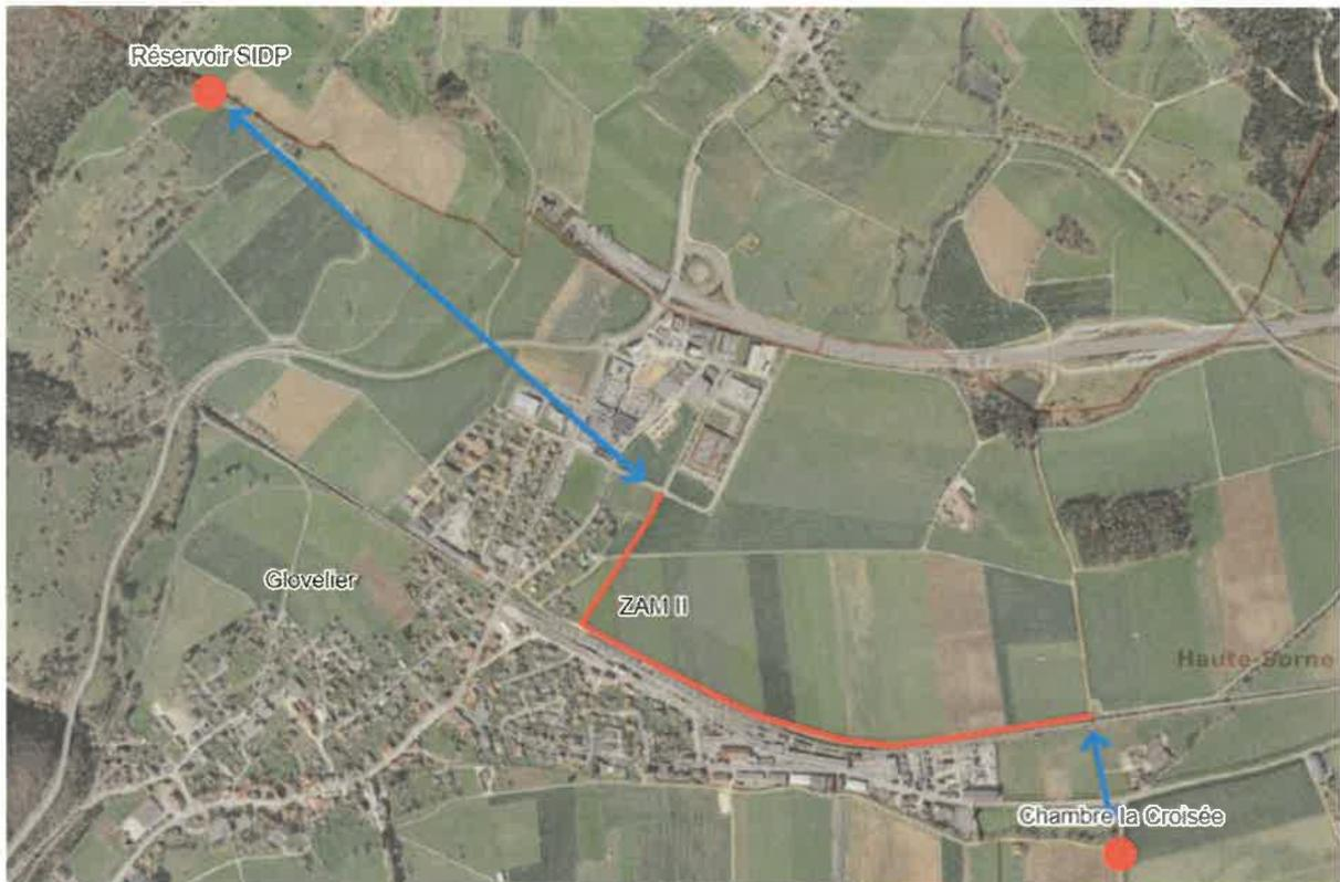
La conduite de contournement reliera la chambre de la Croisée au réservoir du SIDP. Le tracé rouge représente la section intégrée au plan spécial de la ZAM II et pourra être réalisé dans le cadre des travaux de viabilisation, qui doivent débuter avant l'été prochain.
